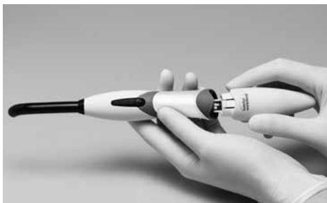
Uzmanīgi ievietojiet rokturi atbilstošajā uzlādes pamatnes balstā, nepielietojot spēku. Ja izmantojat higiēnisko uzdevu, noņemiet to pirms akumulatora uzlādes. Ja iespējams, vienmēr lietojiet lampu ar pilnībā uzlādētu akumulatoru. Tādējādi tiks paildzināts tā darbmužs. Tādēļ ir ieteicams rokturi ievietot uzlādes pamatnē pēc katra pacienta. Ja akumulators ir pilnībā izlādēts, uzlādes laiks ir 2 stundas.
