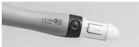
Vložte násadec bez použití síly do otvoru nabíjecí základny. Používá-li se hygienická ochrana, musí se před nabíjením baterie odstranit. Pokud je to možné, používejte lampu vždy s plně nabité baterií. Tím se prodlouží její životnost. Doporučuje se proto násadec vložit po každém pacientovi do nabíjecí základny. V případě úplně vybité baterie činí doba nabíjení 2 hodiny.
