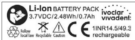
Kérjük, vegye figyelembe, hogy a lítiumpolimer-akkumulátorok nem megfelelő kezelése, illetve mechanikai sérülésre robbanással, tűzzel és füstfejlődéssel reagálhatnak. Sérült lítiumpolimer-akkumulátorok használata tilos.
