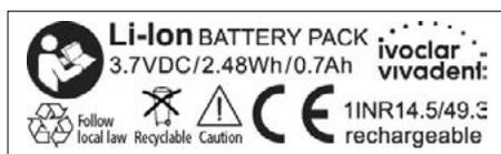
Je třeba vzít na vědomí, že lithium-iontové baterie mohou při neodborném zacházení nebo v případě mechanického poškození reagovat explozí, vznícením nebo tvorbou kouře. Poškozené lithium-iontové akumulátory se nesmí dále používat.
