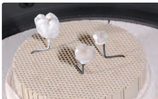
A fényre égetés megfelelő paraméterekkel égetőtálcán történik
