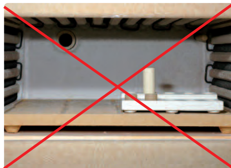
Az IPS e.max Press tablettát és benyomó hengert (Alox Kolben) nem kell előmelegíteni
