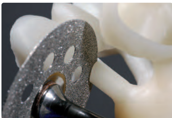
A csapok leválasztása vékony gyémántkoronggal, állandó nedvesítés mellett
