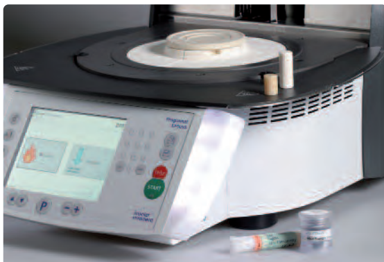
A hideg izolált benyomó hengert és a hideg IPS e.max Press tablettát készítsük elő a kívánt színben
