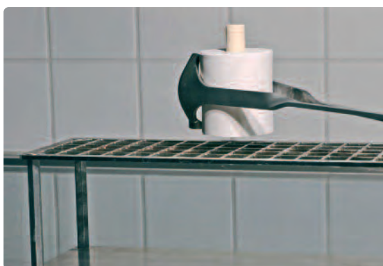
A préselési program befejezése után a forró beágyazást fogóval helyezzük a rácsra és hagyjuk kihűlni
