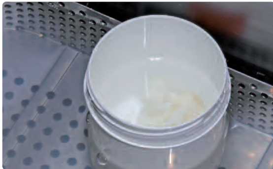
A keletkezett inhibíciós réteget Invex Liquidbe helyezve ultrahanggal kell eltávolítani
