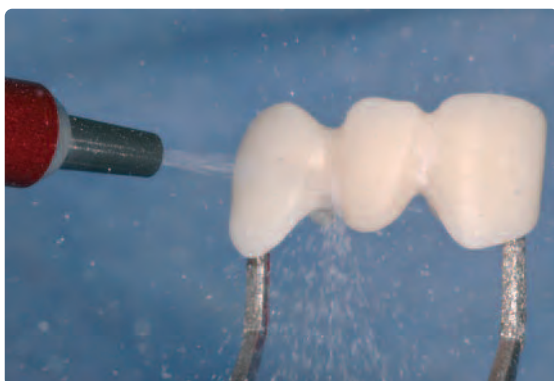
Fújja le a restaurációt 100-as \text{Al}_2\text{O}_3 -al 1 bar nyomással. Alaposan tisztítsa meg a felszínt gőzborotvával, majd szárítsa le a mosóégetés előtt.
