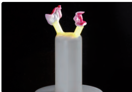
A csapozás az IPS gyűrűn mindig a beömlés irányában, a legvastagabb ponton történjen.
